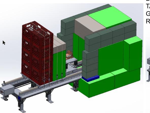
LIGHT GREEN – S4 STEEL BLOCK DARK GREEN – CONCRETE BLOCK TAN – STEEL PLATE GREY – ALUMINUM RED – WATER FILLED PLASTIC CRATE
