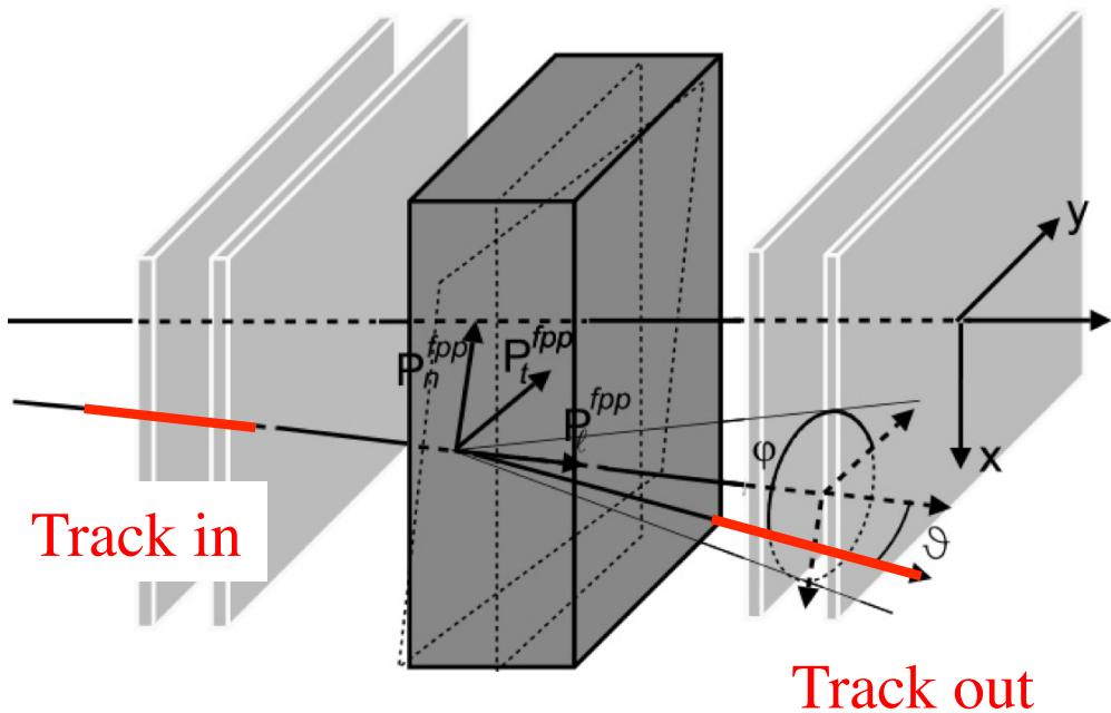
$$f^\pm(\vartheta, \varphi) = \frac{\epsilon(\vartheta, \varphi)}{2\pi} \left[ 1 \pm A_y (P_x^{fpp} \sin \varphi - P_y^{fpp} \cos \varphi) \right]$$
