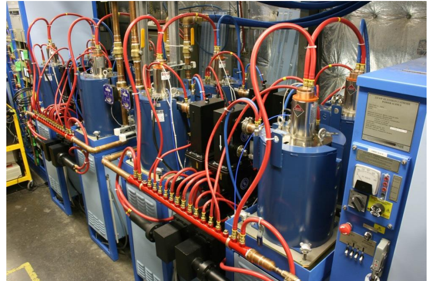
8 x 13 kW klystrons
